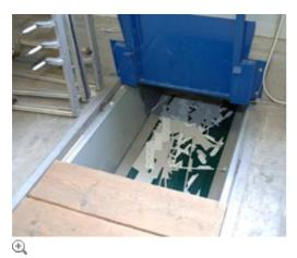
Beim Neubau der Halle vor fünf Jahren wurden viele Details der Faltschachtelproduktion bedacht. So werden die Stanzabfälle über einen Kanal im Fundament aus der Halle ausgeschleust und entsorgt (5)
